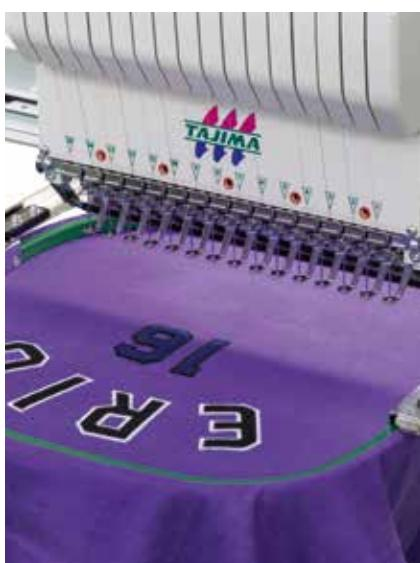
Infine, risolve il problema della carenza di manodopera visto che “i-TM” facilita e semplifica il compito degli operatori senza esperienza che possono non essere iper-specializzati, non dovendo più preoccuparsi di regolare la tensione del filo manualmente.
